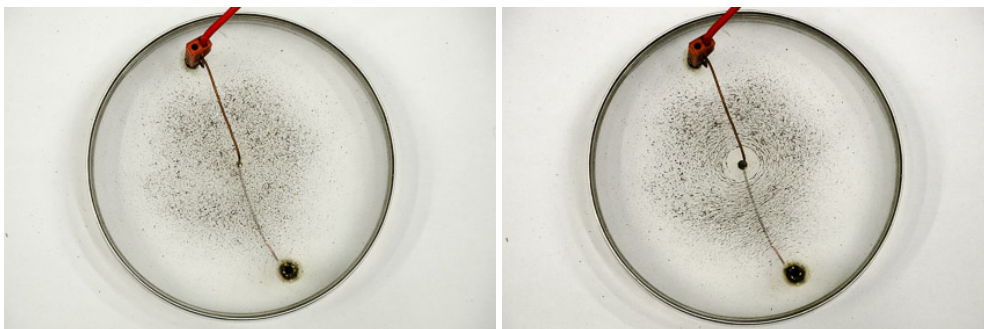
Opilki okrog navpične ravne žice pred vključitvijo toka (levo) in po vključitvi (desno).
