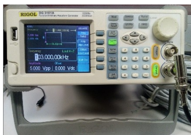
Generator pravokotnega signala
