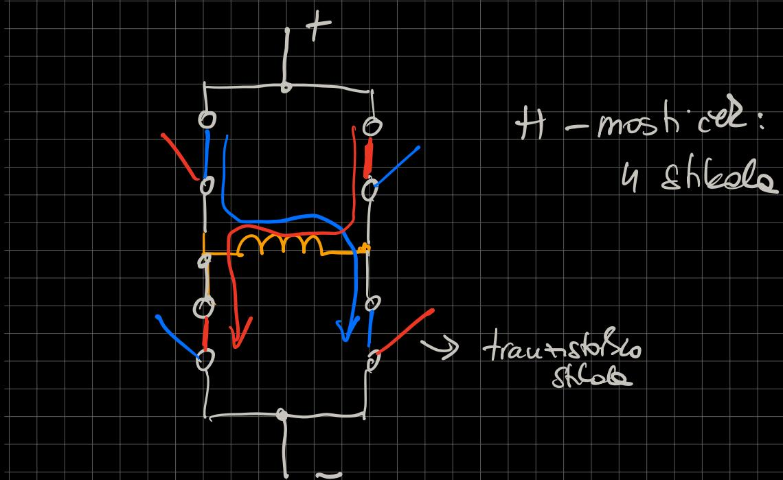
Za krmiljenje bipolarnega motorja (= motorja z 2 navrtji)
