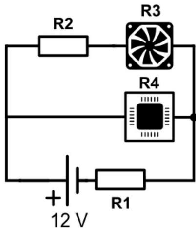
2. Poišči napetost med točkama a in b, kjer je  $R_1 = 1 \Omega$  in  $R_2 = 2 \Omega$ . Kolikšna moč se troši na uporu  $R_2$ ? Rešitev:  $U = 10/3 \text{ V}$ ;  $P = 0,22 \text{ W}$
