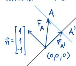
$$\vec{r}_{A'} = \vec{r}_A - \text{proj}_{\vec{n}} \vec{r}_A = \vec{r}_A - \frac{\vec{n} \cdot \vec{r}_A}{\vec{n} \cdot \vec{n}} \vec{n} = \begin{bmatrix} 3 \\ 6 \\ 3 \end{bmatrix} - \frac{6}{3} \begin{bmatrix} 1 \\ 1 \\ -1 \end{bmatrix} = \begin{bmatrix} 1 \\ 4 \\ 5 \end{bmatrix} \dots A'(1, 4, 5)$$
